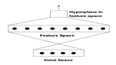
图 3.3 支持向量机将输入矢量非线性地映射到高维特征空间中
