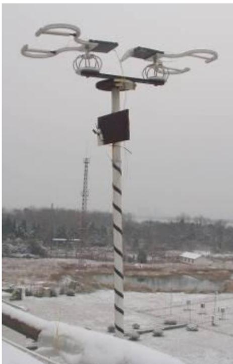
高精度光纤大气光学湍流强度与结构测量系统
