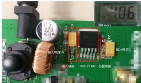
图 3-6 MIC29302 电路测试图
