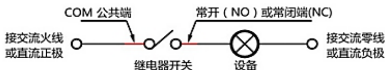
图 3-24 继电器控制外设原理
