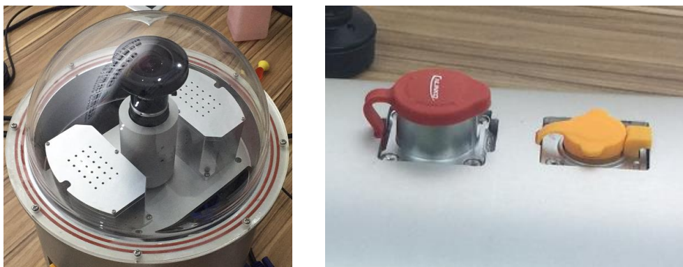
a) 防水胶圈（红色部分） b) 防水电源接口（红色）及网线接口（黄色）
